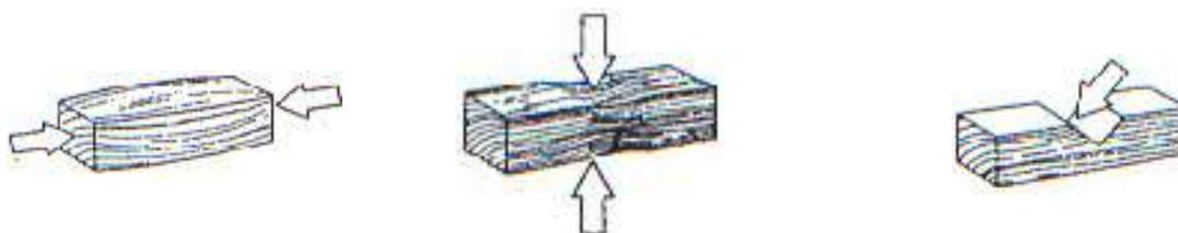
(a) compressão paralela às fibras (b) compressão perpendicular às fibras (c) compressão inclinada em relação às fibras
